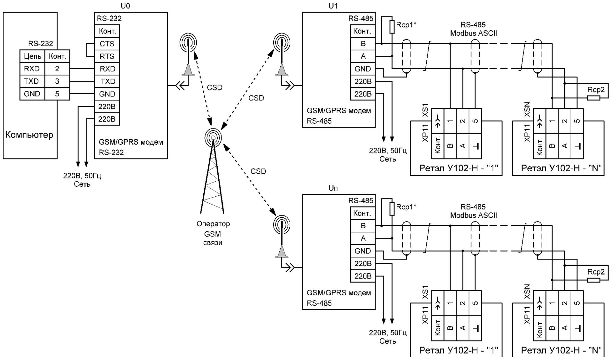
\*При наличии внутреннего согласующего резистора в GSM/GPRS модемах резисторы Rcp1 не устанавливаются.
