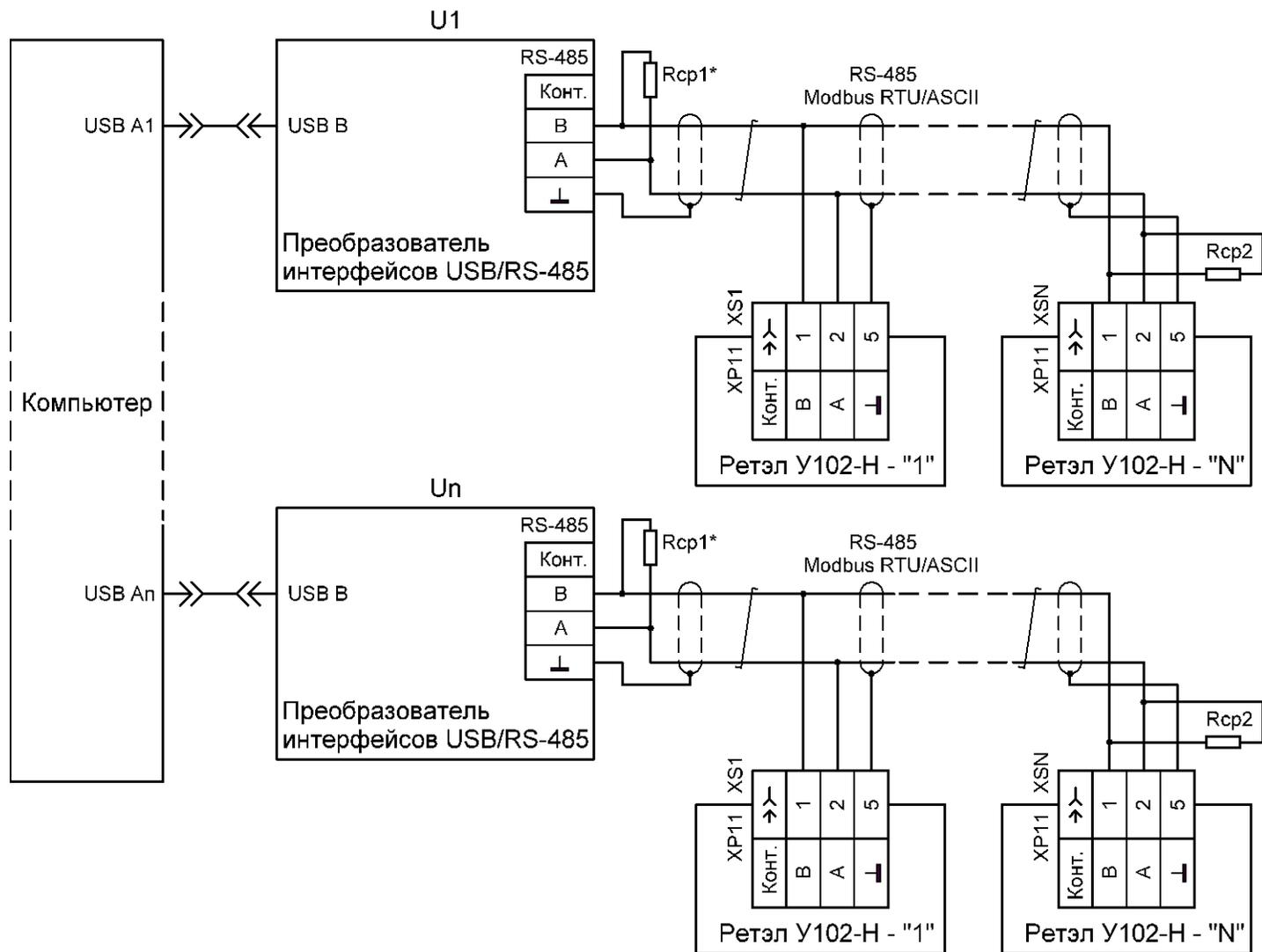
\*При наличии внутреннего согласующего резистора в преобразователях интерфейсов USB/RS-485 резисторы Rcp1 не устанавливаются.
